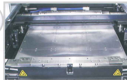
高精度PCB厚度的调节顶升平台 High precision adjustable PCB thickness lift up platform
